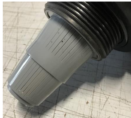
Dysan som ska sitta på automatikens undersida.
