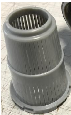
Dysan som ska sitta på automatikens undersida.
